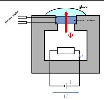
Un four est alimenté en puissance via un circuit électrique en régime continu. La chambre est censée supporter des température **inférieures à**  $60\,^{\circ}\mathrm{C}$ . L'enceinte est calorifugée, sauf au niveau d'une ouverture où on laissera s'échapper le flux thermique à travers le matériau qui nous intéresse. Pour augmenter l'efficacité du transfert, on place une poche étanche de glace pilée au dessus du matériau.
