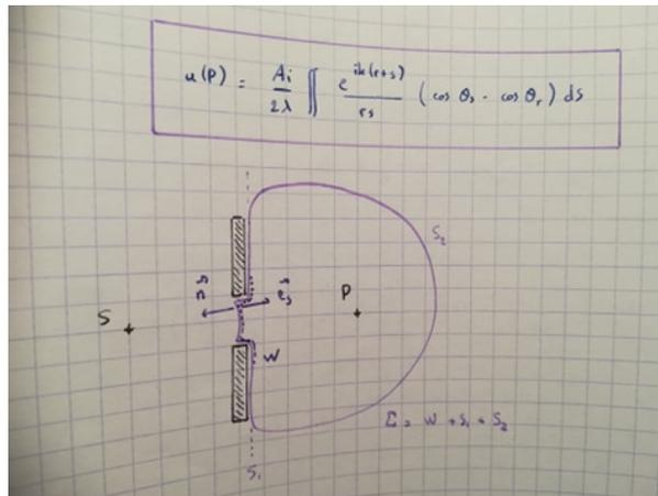
FIGURE 1.3 – Le calcul de l'intégrale se fait sur une surface comprenant l'objet diffractant (ici noté W). L'intégrale se calcule sur  $W + S_1 + S_2$  et on montre que la contibution de  $S_1 + S_2$  est nulle donc elle se calcule seulement sur l'ouverture  $\Sigma$  (ici W)
