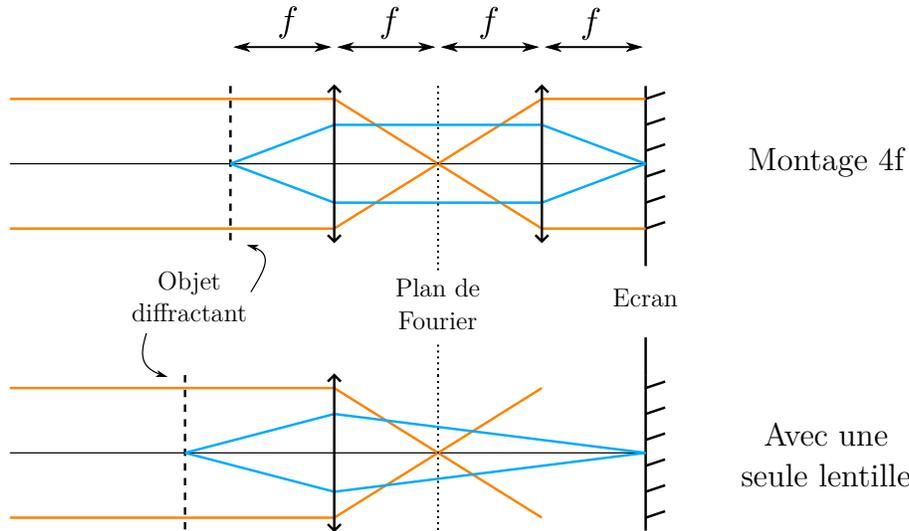
FIGURE 1.4 – Différents montages utilisés pour visualiser le plan de FOURIER ou l'image de l'objet
