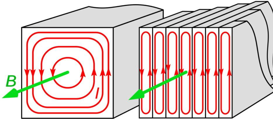
FIGURE 3.1 – Feuilletage d’un ferro qui permet de limiter les pertes par courants de Foucault
