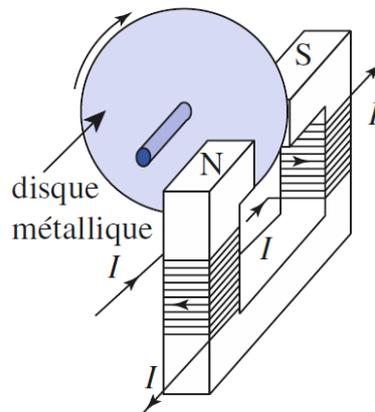
FIGURE 3.3 – Système de freinage par induction
