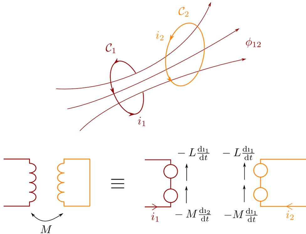
FIGURE 2.1 – Schéma équivalent, évidemment il y a une erreur un  $i_2$  est devenu un  $i_1$ ...
