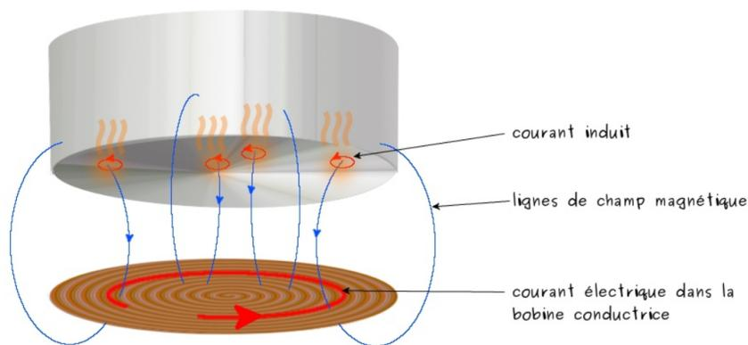
FIGURE 3.2 – Chauffage par induction
