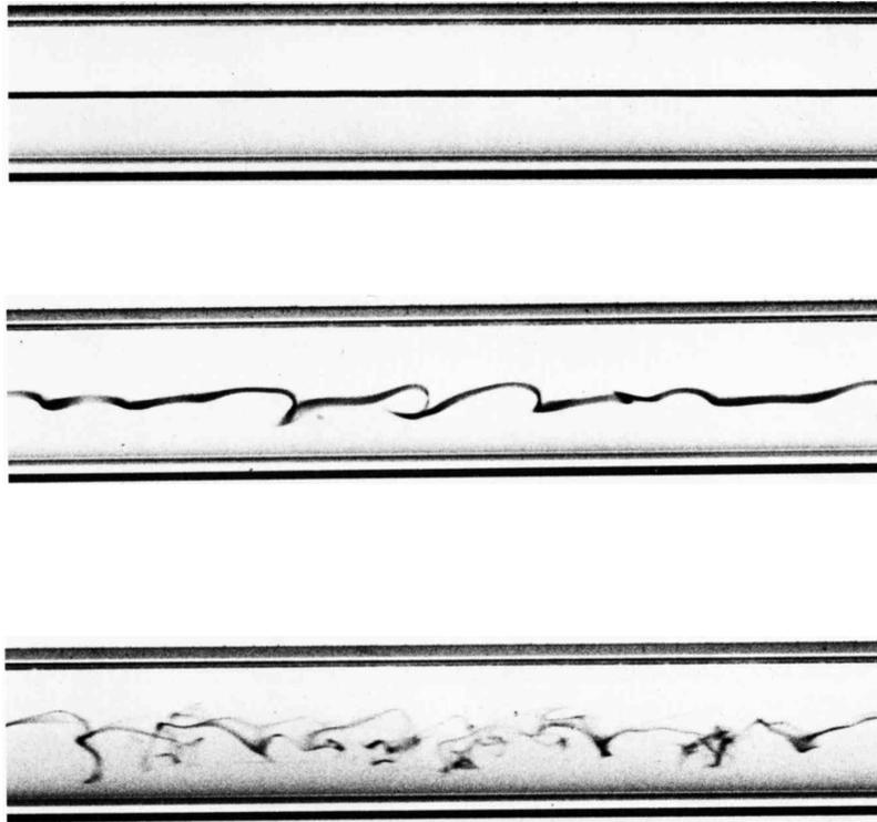
FIGURE 2.1 – Des écoulements à différents nombre de REYNOLDS. Extrait de *An album of fluid motion* de Van Dyke.
